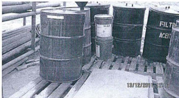
Foto N° 7.- OBSERVACION N° 2-2011.- El titular minero implementará sistema de contención, para evitar posibles derrames y/o fugas de residuos peligrosos líquidos como aceites residuales en el almacén de hidrocarburos.
