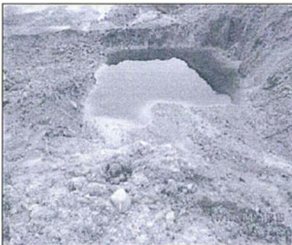
Foto N° 41.- Incumplimiento Observación N° 3, Supervisión 2010: Continúan los afloramientos en el tajo Suro Sur, los cuales no son captados ni derivados a las pozas de tratamiento.
