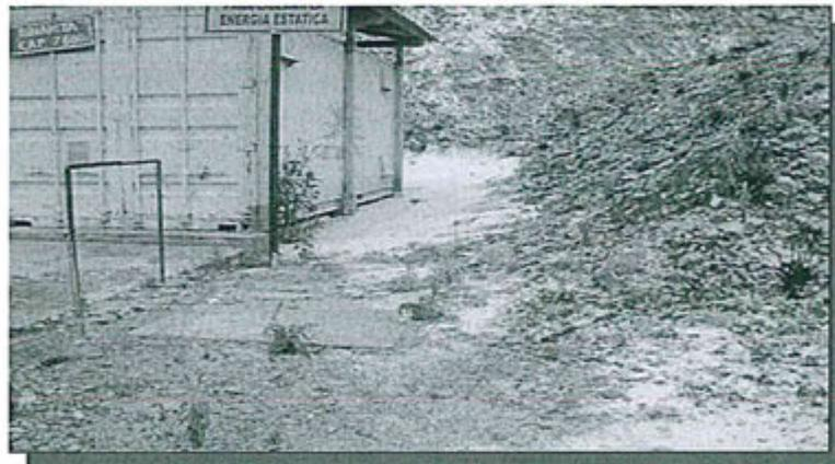
Foto 3: Polvorín, obsérvese la escorrentía de las lluvias están en contacto con los containers metálicos (Anfo, accesorios de voladura y dinamita), afectando al suelo por lixiviación. Coordenada UTM 9 367 528 N, 169 715 E (Datum WGS 84).
