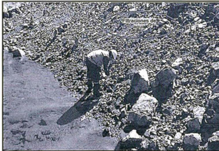
Fotografía N° 18: Toma de muestra del agua infiltrada de la parte inferior del dique auxiliar de la Poza de Agua Retenida.
