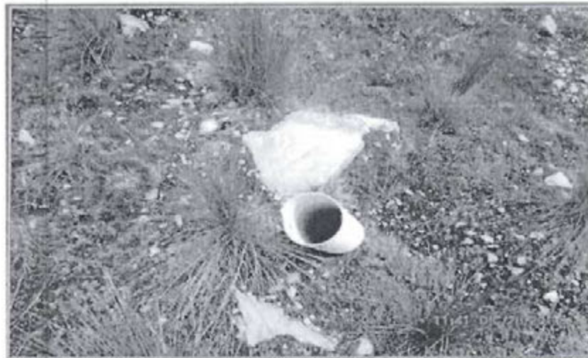
Fotografía N° 18: Recomendación N° 3. En la zona Campamento se constató un tercer taladro diamantino que no está taponeado
