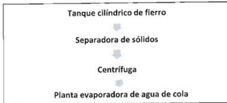
Gráfico N° 2: Tratamiento de los efluentes de proceso "sanguaza" de la planta de harina residual asumido en el EIA
