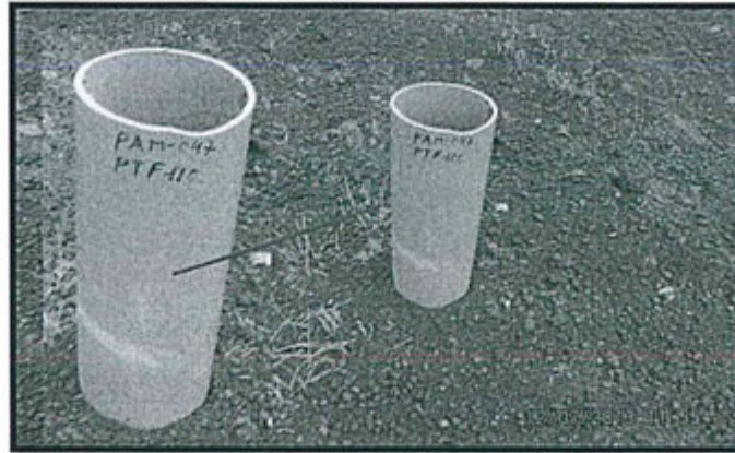
Fotografía N° 42. Hallazgo N° 3 Sondaje de Perforación Diamantina PAM-047. Vista fotográfica de la tubería insertada al sondaje diamantino PAM-047, ubicado en la Plataforma de Perforación PTF-110.
