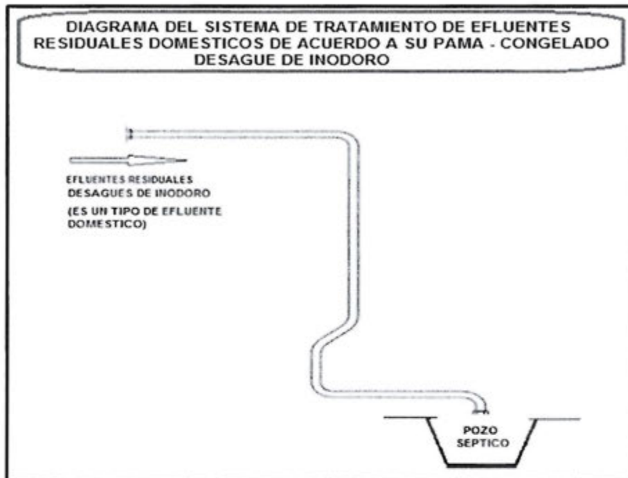
Gráfico N° 3: Tratamiento de efluentes provenientes de los sanitarios
