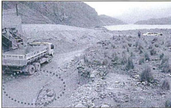
Fotografía N° 12 del Informe de Supervisión: Otra vista de la tolva para almacenamiento de mineral en Tinquicocha, presenta agua anegada con riesgo de afectar la laguna Tinquicocha.
