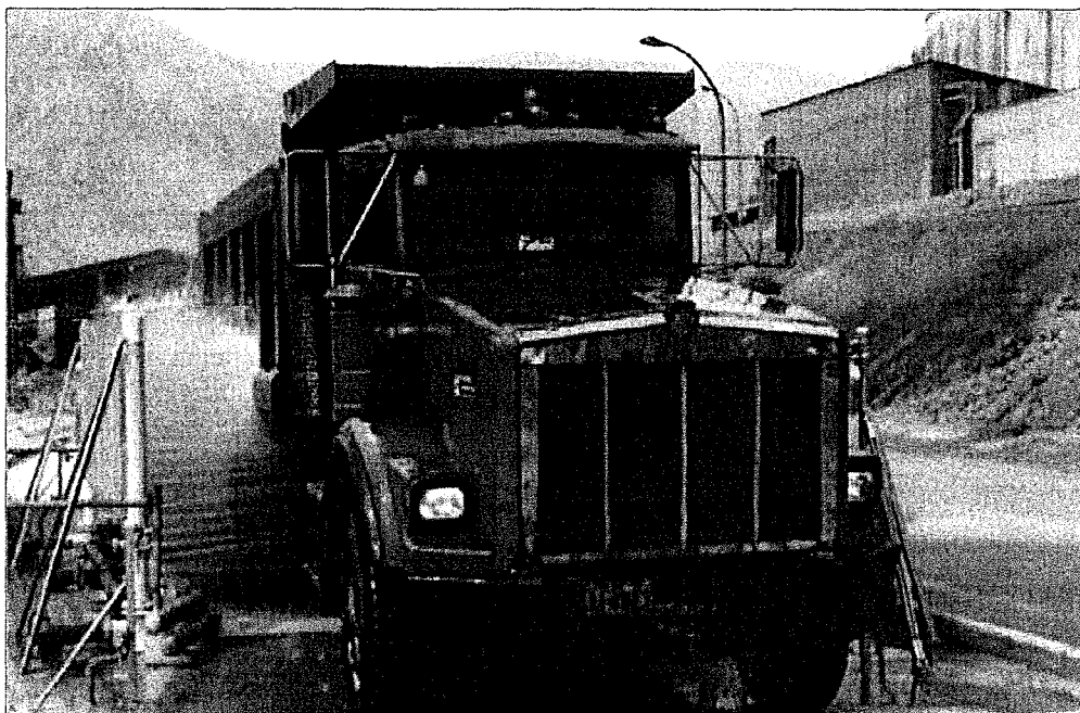
Fotografía 8. Sistema de lavado de camiones
