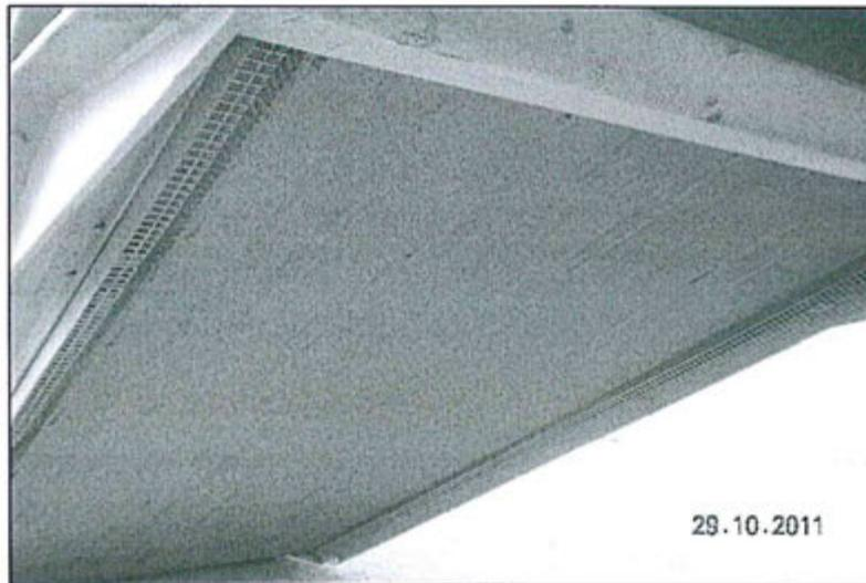
Fotografía N° 2 del Informe de Supervisión: Faja Transportadora del Samson, la cual no se encuentra confinada, permite la generación de material particulado fugitivo.
