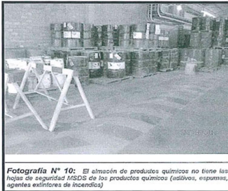
**Fotografía N° 10:** El almacén de productos químicos no tiene las hojas de seguridad MSDS de los productos químicos (aditivos, espumas, agentes extintores de incendios)
