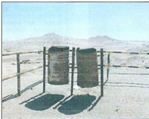
**Fotografía N° 13:** Se observan dos (2) cilindros deteriorados y sin rótulos en la Batería N° 12.
