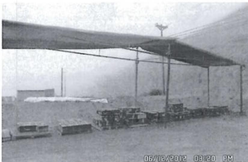
Fotografía N° 76.- Supervisión Regular 2012, Observación N° 6, Disposición de baterías usadas y otros residuos peligrosos, sin una medida de contención secundaria para la protección del suelo y no cuentan con barreras de protección.
