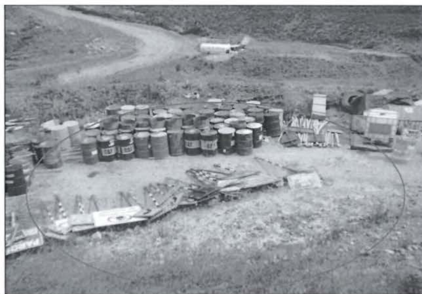
Fotografía N° 9: Almacenamiento de materiales y sustancias peligrosas a nivel del taller de mantenimiento Arpón de la Contratista San Martín, directamente sobre el suelo natural sin impermeabilizar, Recomendación N° 3, UM Cerro Corona, 2011
