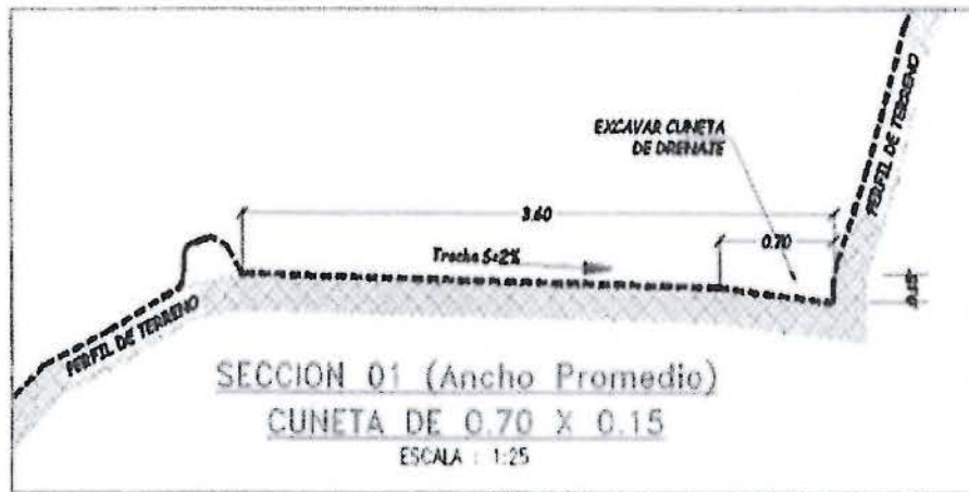
Fotografía N° 5 Sección típica Vía de acceso a Dique de Relavera Asnapampa
