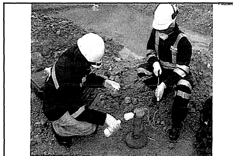
Foto N° 179. Observación N° 8-2012: Vista del filtrado en campo de la muestra tomada con código TYN-01 para su análisis por el laboratorio Inspectorate.
