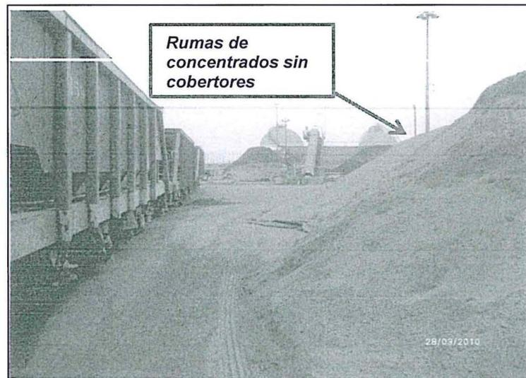
Fotografía N° 25 del Informe de Supervisión.- Lugar de descarga de concentrados del Ferrocarril, se observa ruma de concentrado sin cobertura, concentrado regado sobre el pavimento, el cual al secarse y con la presencia de corrientes de aire este se eleva, produciendo polución.
