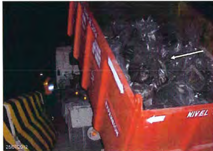
Fotografía N° 30: Carguío inadecuado de los residuos peligrosos.
