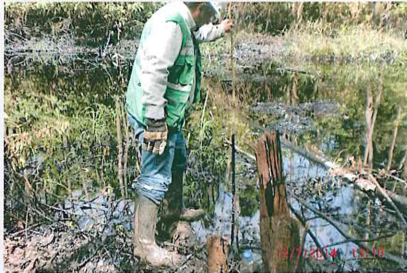
FOTO N° 43: N 9474623, E 468155 / zona del canal de Flotación con presencia de petróleo Crudo, ubicado a una distancia de 200 mt. del Campamento de Trabajos de Remediación. De acuerdo al resultado de la medición de nivel del Agua del Canal se tiene determinado un espesor de Petróleo de 44 cm.
