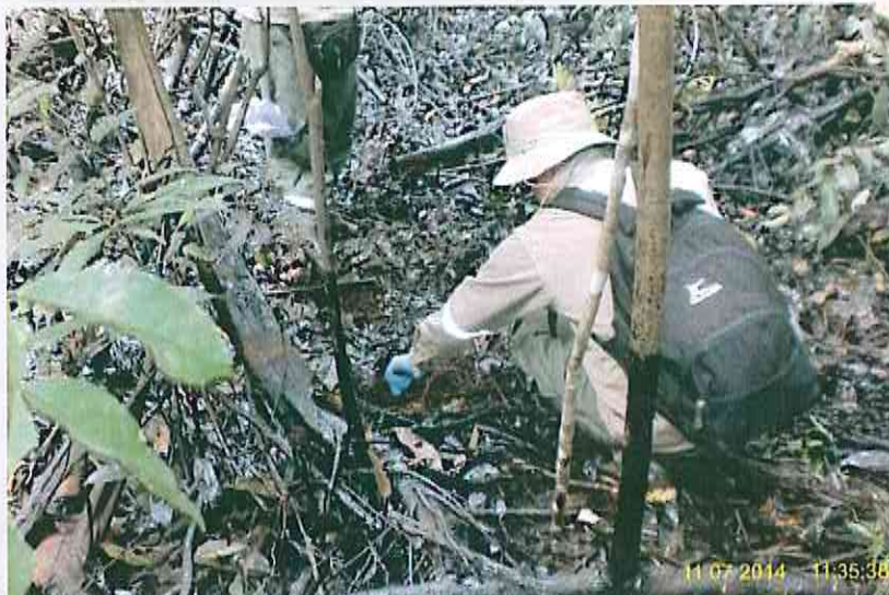
FOTO N° 21: N 9474492, E 468024 / Zona de suelos impregnados con petróleo crudo, ubicado al margen derecho del caudal del Canal de Flotación, con un ancho de 40 mts. a partir de las orillas del canal, al lado opuesto del campamento de remediación. Se procedió a tomar muestras de suelo.
